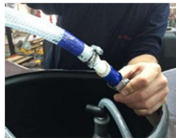
Unir al tramo de manguera saliente del AirLift del digestor también identificado con etiqueta azul.
