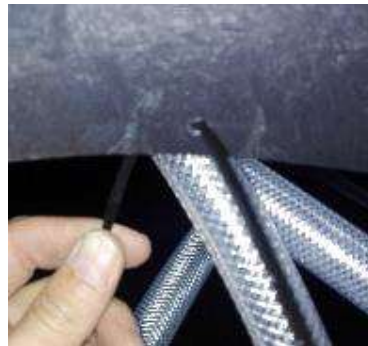
Sujertar la Y al marco del depósito por medio de una brida.
