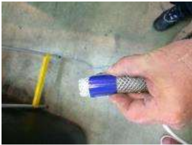
Cortar tramo de manguera Dn16 e identificar con etiqueta azul.
