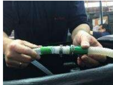
Unir al tramo de manguera saliente del AirLift del digestor también identificado con etiqueta verde.
