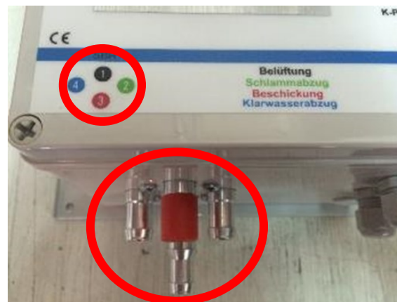
Imagen 11 Entronques para la conexión de las mangueras en el cuadro eléctrico
