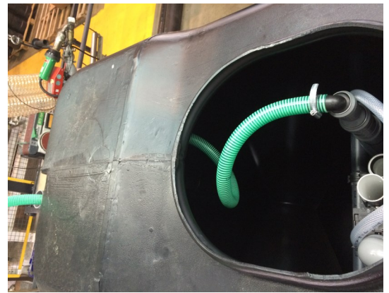
Imagen 5 Manguera corrugada en entronque del Air-Lift. Sale del depósito por el lateral hacia el depósito contiguo.
