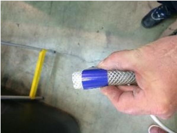
Imagen 6 Manguera que se conectará a la identificada en color verde del Air-Lift
