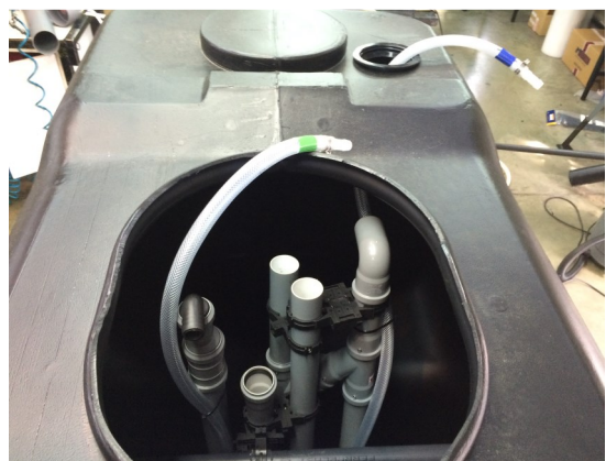
Imagen 3 Sistema Air-Lift instalado en el digestor. Vista de las mangueras neumáticas.
