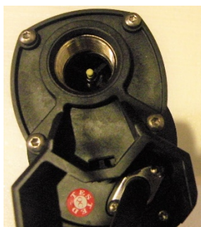
Detalle de conexión de salida de bomba
