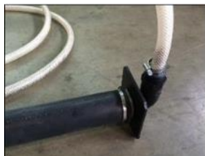
Fotografía 5: conexión manguera a difusor.
